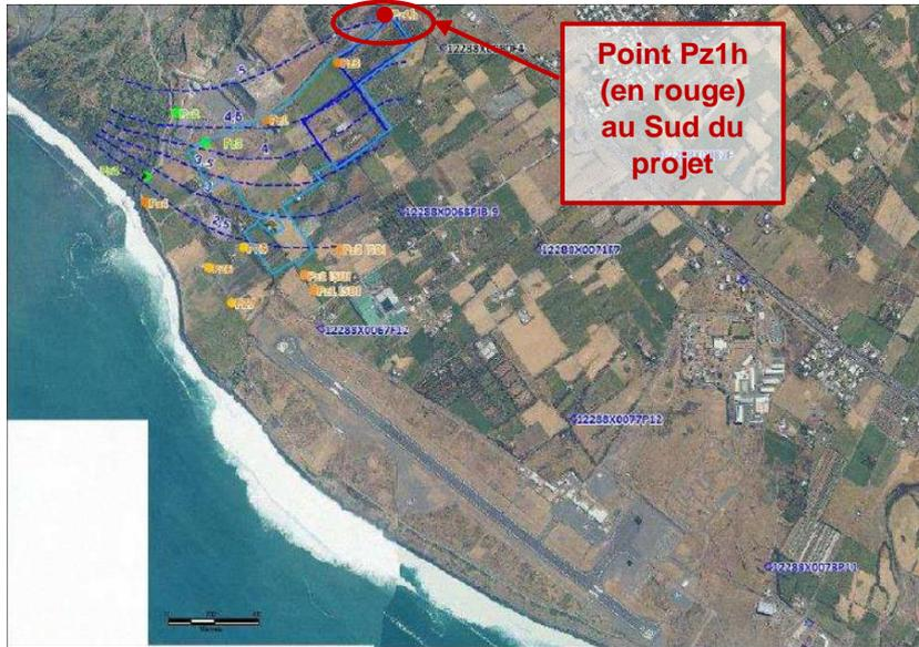
Figure 3 : Piézométrie de la nappe de Pierrefonds en période de hautes eaux dans le voisinage du projet - Source : ANTEA
